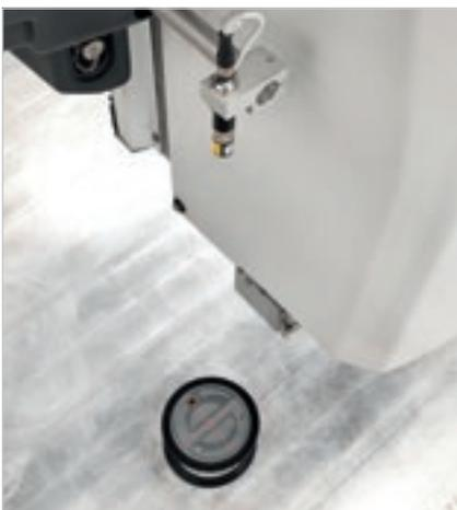
Il laser a croce guida l'operatore nel posizionamento di ventose e battute velocizzando le operazioni di allestimento del piano.
