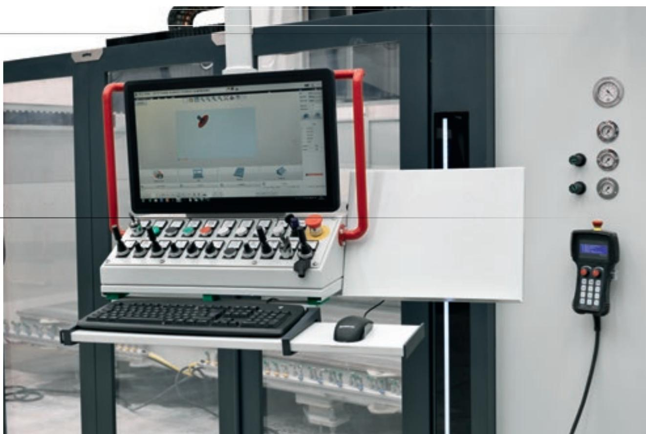
L'utilizzo di un PC con sistema operativo Windows garantisce un approccio estremamente facile e intuitivo nell'utilizzo da parte dell'operatore e la totale connettività con i sistemi di rete e con i supporti ottici/magnetici reperibili sul mercato.
